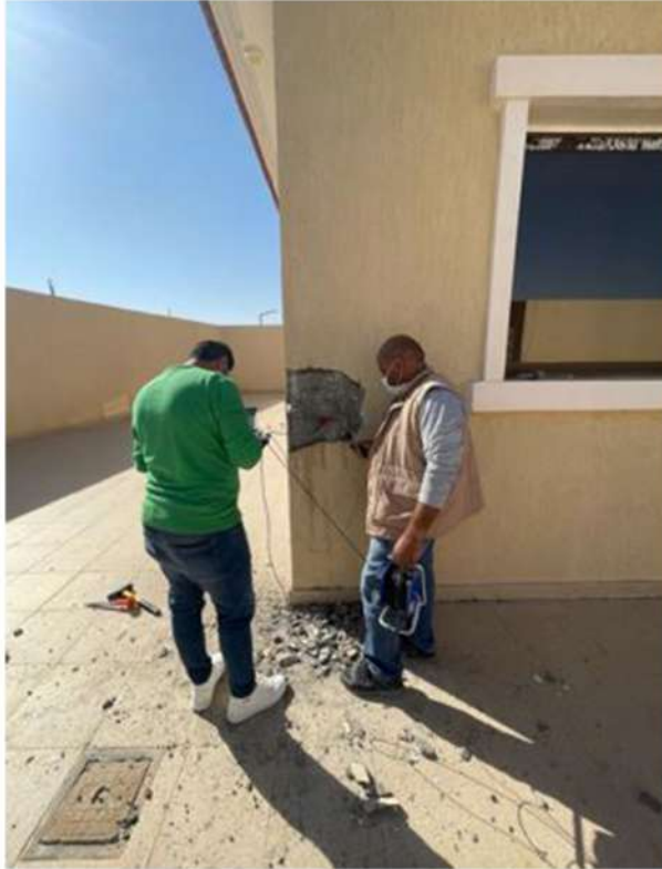
تنفيذ اختبار HALFCELL بالاعمدة
