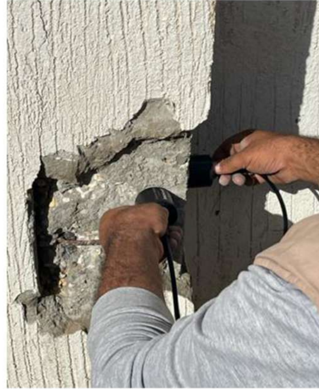
تنفيذ اختبار ULTRA SONIC بالاعمدة
